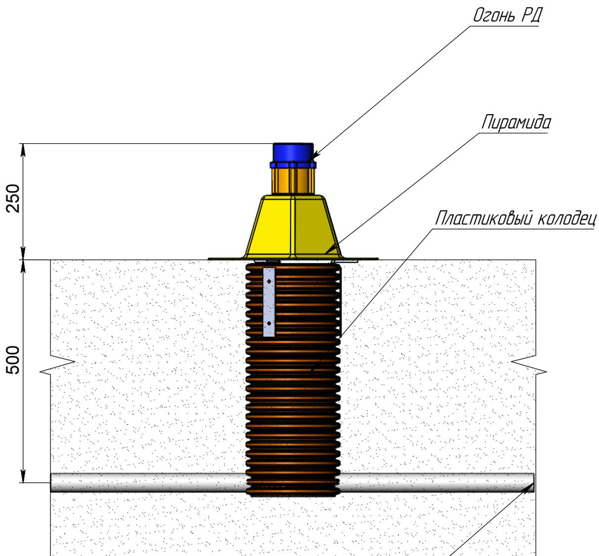
Труба для кабеля питания  $D=40\text{мм.}$
