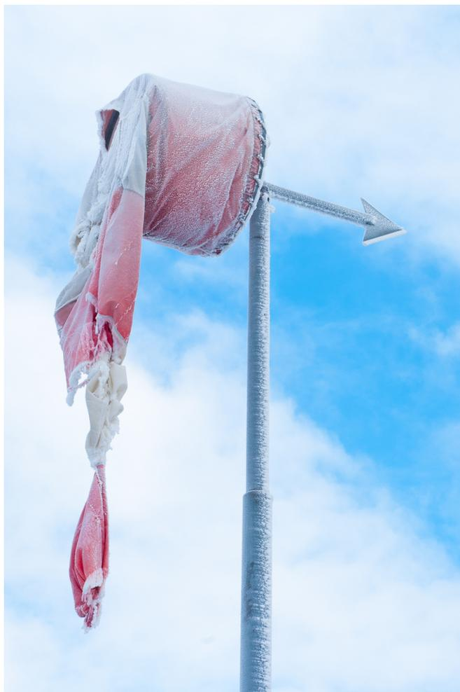
Частота смены тканевого конуса очень зависит от конкретного места установки. Для средней полосы России характерны следующие периоды: Условно китайский или иной тканевый конус, сшитый народными умельцами - 6 месяцев, максимум, до физического разрушения. Тканевый конус из тафеты, сшитый по технологии - 1 год и более до физического разрушения. Тканевый конус из плотных тканей - 2-3 года до выгорания цветовой окраски ткани и + 1-2 года до физического разрушения.
